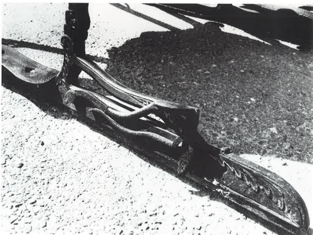
Arreslee, detail: glijder met rem, zijn 'dubbele constructie'.
