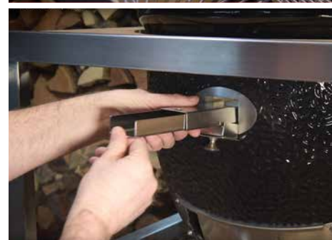
Duw de rookpellets / houtsnippers tot direct boven de houtskool naar binnen, trek de schuif open, verwijder dan de schuif en sluit vervolgens het klepje.
